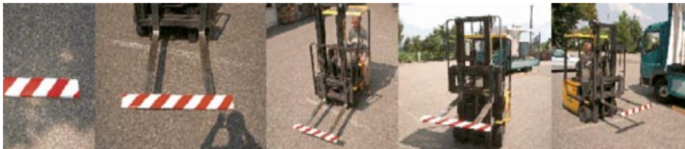
Schutzkappe mit Warnstreifen nehmen Gabelzinken „die Spitzen“ und sind weithin sichtbar Quelle: Ingenieurbüro Dipl.-Ing. Harald Diemer, Neustadt/Weinstraße
