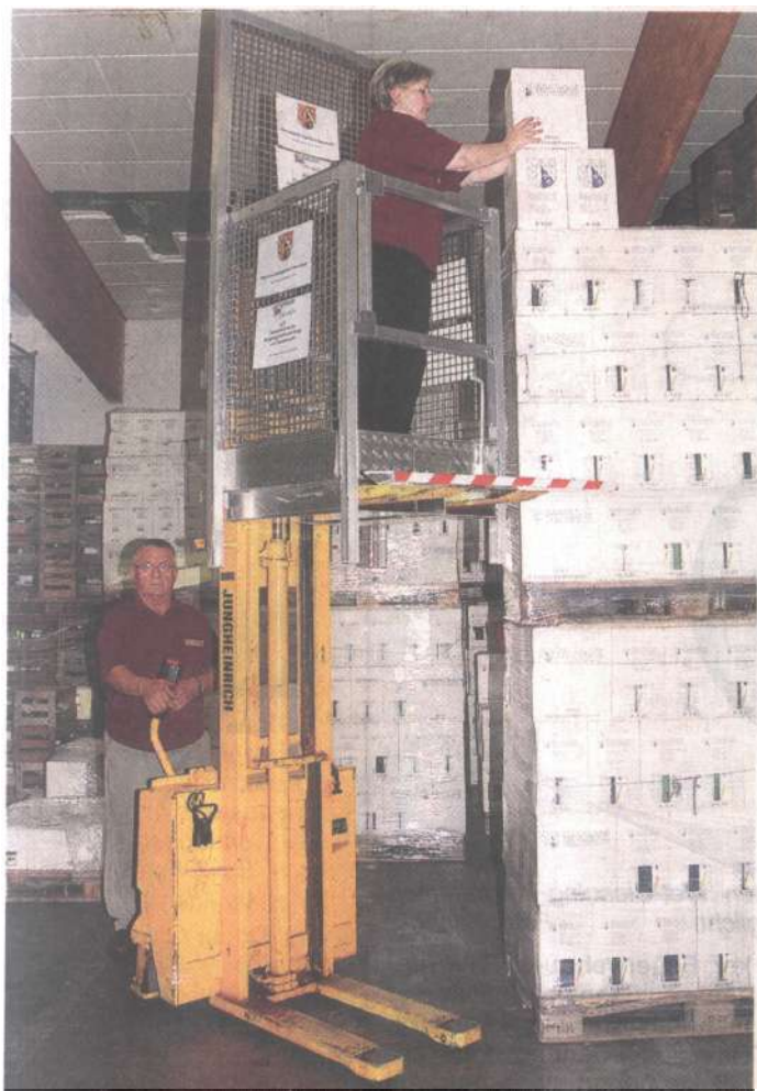
Die Arbeitsbühne ADS ist für an hochgelegenen Stellen auszuführenden Arbeiten eine kostengünstige und sichere Lösung, wie Gabriela Kurz und Lorenz Münch unter Alltagsbedingungen in der Lagerhalle testeten. Foto: Schönig
